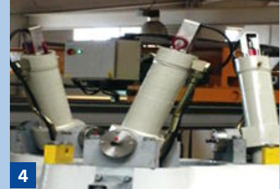
Pitchzylinder mit optimierten Haltezapfen.
